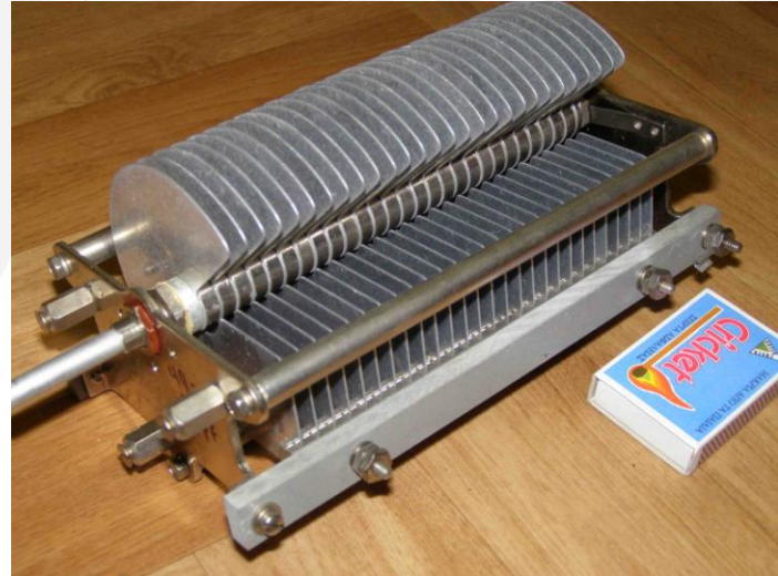
चित्र 11.17: परिवर्तनशील वायु संधारित्र। (Source: freewebs.com)
