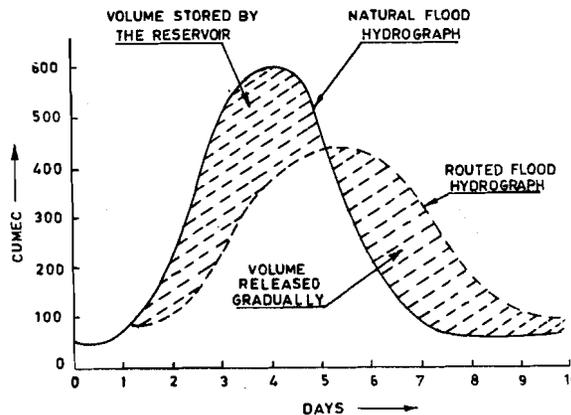
Figure 1.1 : Flood Routing : Definition Sketch
