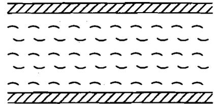
Figure 3.2 (b) : Turbulent Flow
