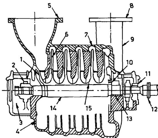
Figure 11.4 : Sectional Drawing of a Typical Five-stage, Uncooled, Horizontally Split Centrifugal Compressor 1) Guide Vane 2) Thrust Bearing 3) Bearing Housing 4) Casing 5) Inlet Flange 6) Diaphragm 7) Diffuser 8) Discharge Flange 9) Volute 10) Thrust Balancing Drum 11) Shaft Bearing 12) Coupling 13) Seal 14) Shaft 15) Impeller
