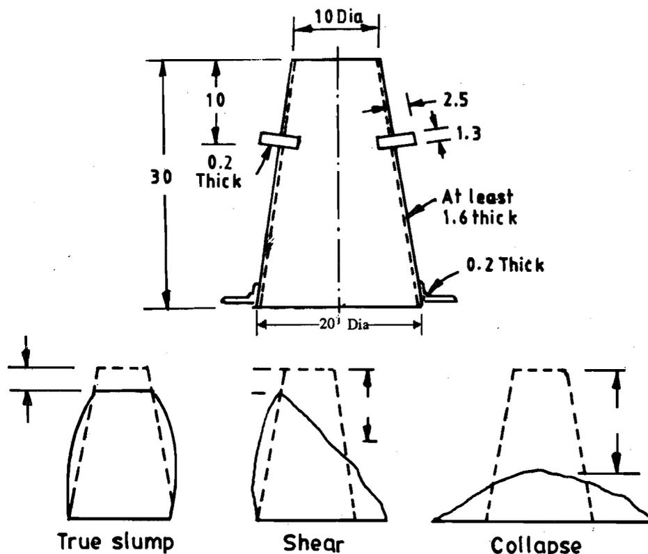
Figure 5.1 : Slump Test
