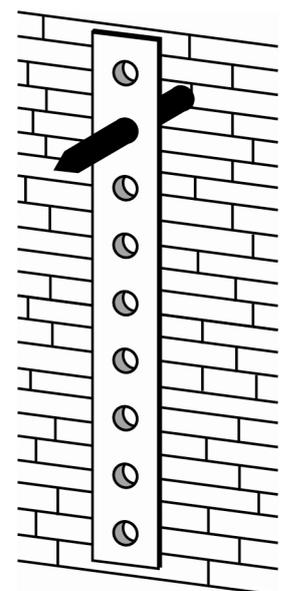
**Fig.1.5: A bar pendulum**
