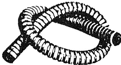
Fig. 9.1 Metallic flexible conduit
