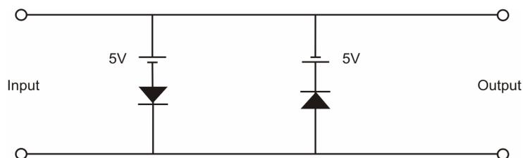
Fig. 2.18: Diode Clipper
